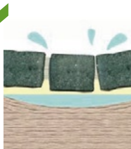
Joints perméables : infiltrations d'eau
