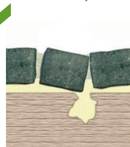
Compactage insuffisant ou porosité de la fondation
